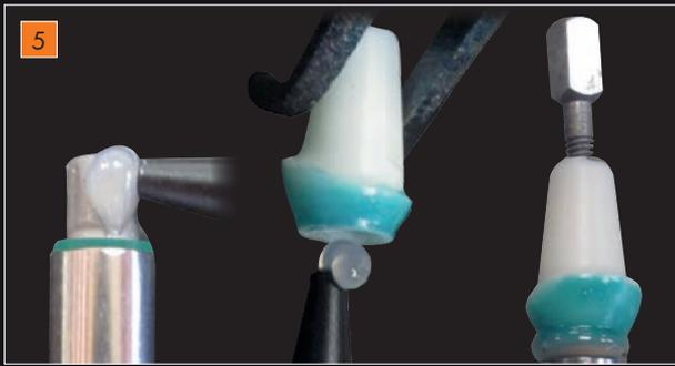
DTK-Kleber (transparent oder opak) aufbringen, Abutment auf die Klebebasis drücken, danach Schraube in Kanal einführen.
