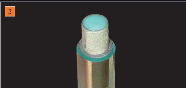
Schraubenkanal mit Wachs verschließen
